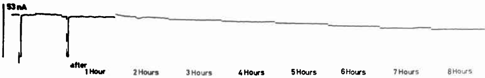
図8 時間的経過と電流値 3時間を境に急激な電流値の低下が認められた。
